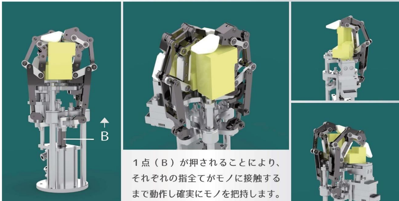
図 2 自分の指の部位が当たる位置まで屈曲して止まるため、指 1 本 1 本が把持する対象物の形状に合わせる形で止まる、指同士がなじむ動作。（提供：ダブル技研株式会社）
