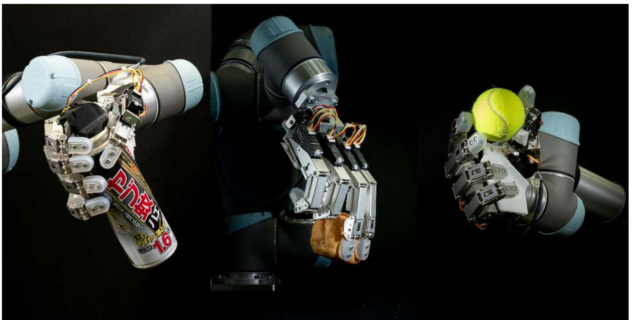
写真 16 それぞれの指が独立して駆動。4 本の指で缶を保持しながら、人差し指だけでスプレアの噴射のオンオフが可能なのもこのモデルならではの。シュークリームのような柔らかい物も、モーターの出力制御により、潰さずに持ち上げることができる。（提供：ダブル技研株式会社）
