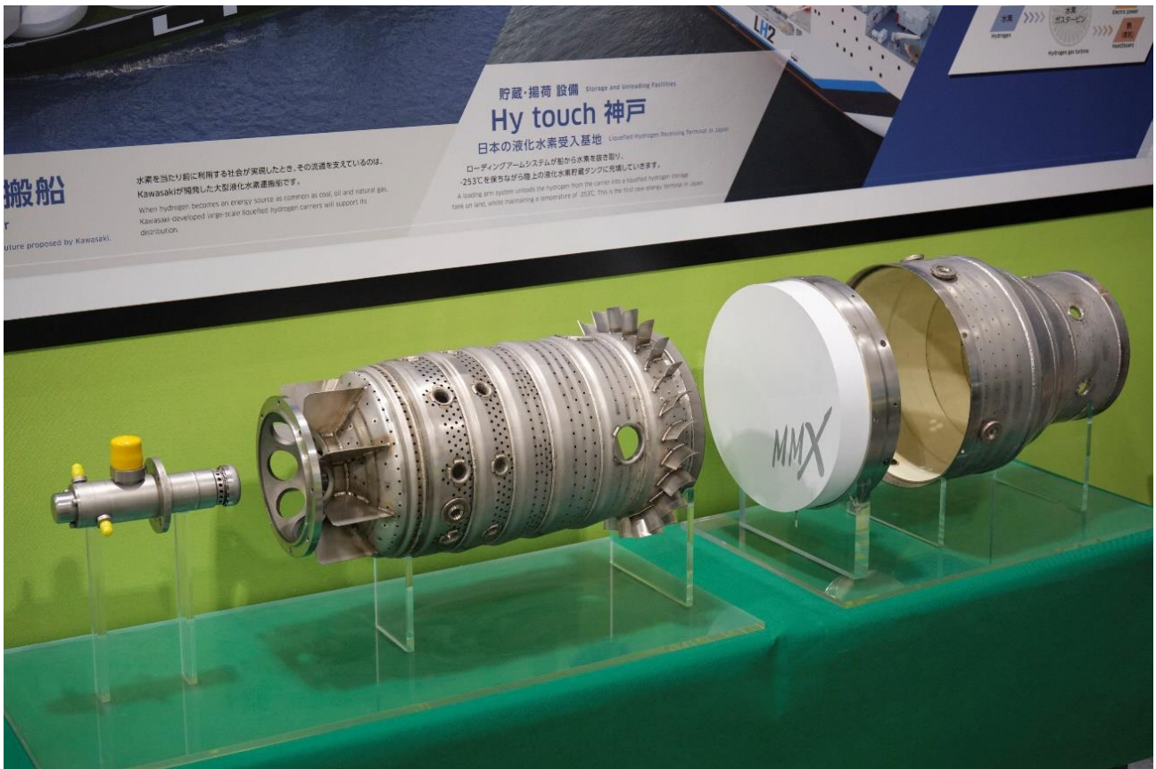
写真3 マイクロミックス燃焼器（右）とウェット方式燃焼器（左）のサンプルモデル
