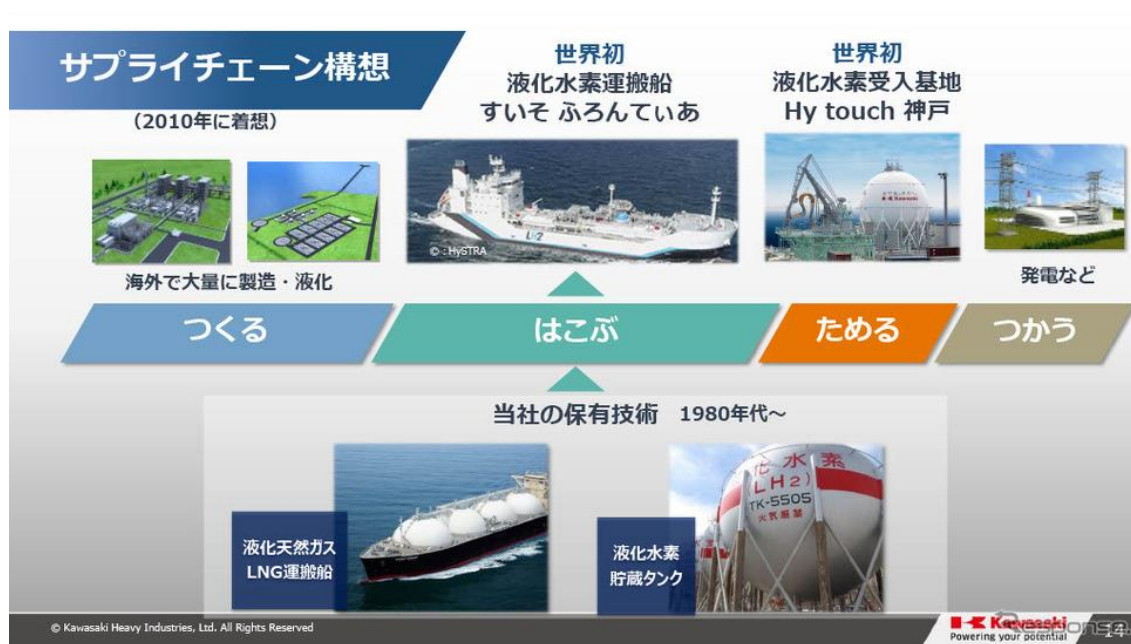
図 1 CO 2 フリー水素サプライチェーンのコンセプト (提供：川崎重工業株式会社)
