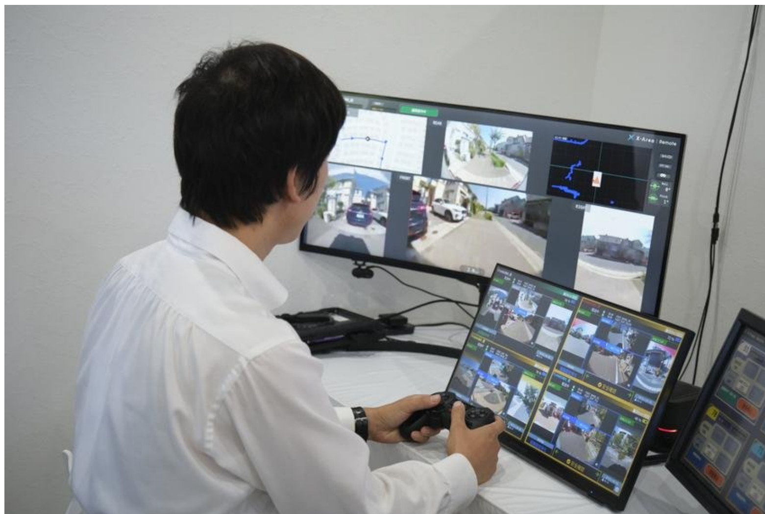
写真7 遠隔監視・操作者1名でハコボ4台のフルリモート運用する様子(資料提供:パナソニックHD株式会社)
