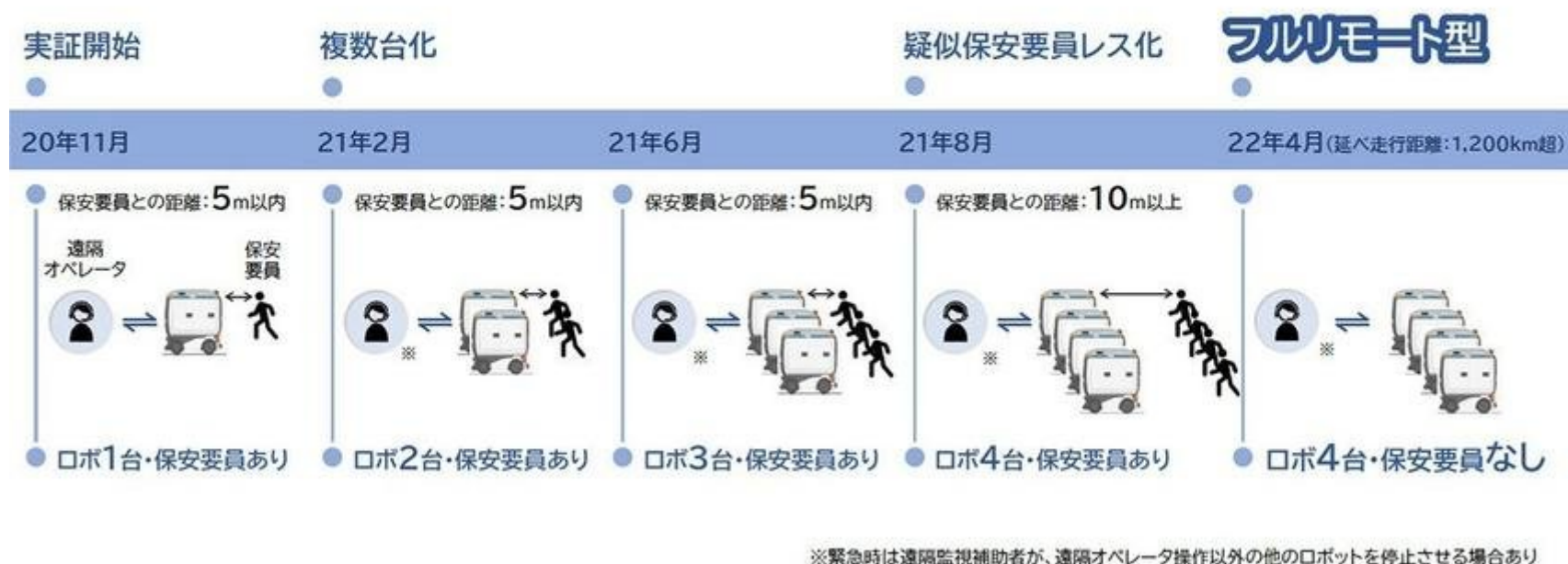
図1 遠隔監視・操作者1名でロボット4台のフルリモート運用を実現(資料提供:パナソニックHD株式会社)
