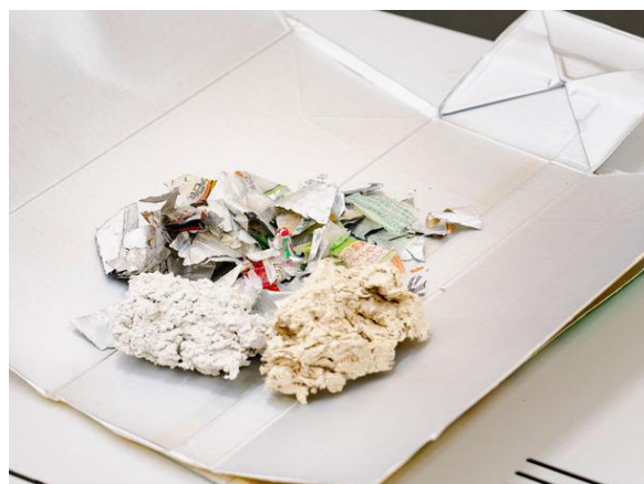
写真6 パルパー型分離機で分離回収された紙パルプとプラスチック付きアルミ
