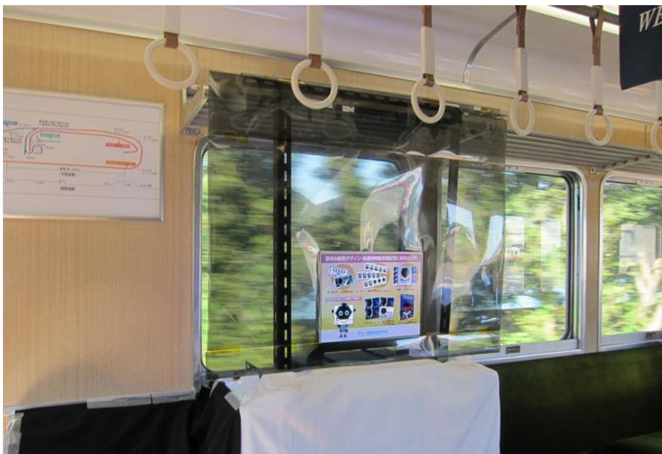
**写真8** 三菱重工業の実験線では、窓に透明ディスプレイを設置。楕円形の実験線のため、さまざまな状態の外光が窓から降り注ぐ。この検証では、スモークフィルムを垂らすことで、スモークガラスの場合にどうなるかの検証も行われた（資料提供：シャープディスプレイテクノロジー株式会社）
