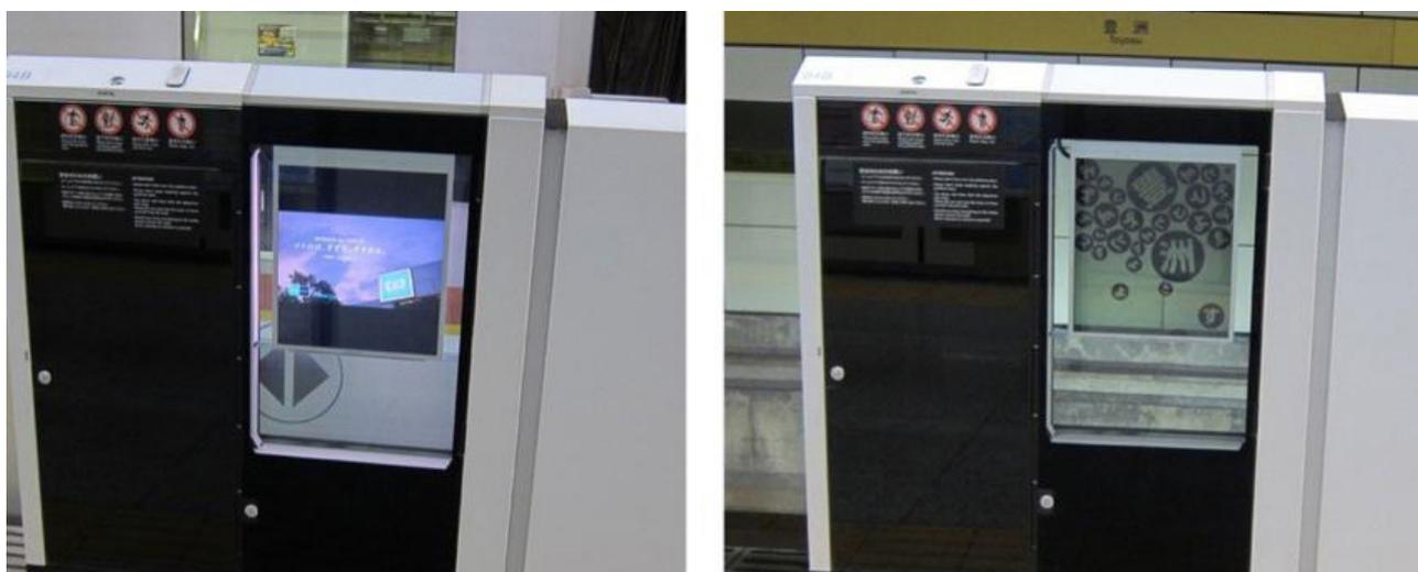
写真4 豊洲駅の転落防止柵に設置された透明ディスプレイ。カラー表示できちんと映像として認識できる（左）。モノクロ表示だと、背景が透けて見えるのがよくわかる（右）（資料提供：シャープディスプレイテクノロジー株式会社）
