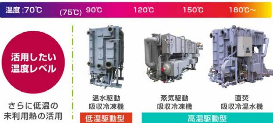
図3 従来の熱駆動型吸収冷凍機の駆動温度帯。従来の吸収冷凍機では、75°C未満の温水（廃熱）では冷房に利用可能な冷水（7~8°C）を得ることは難しく、低温廃熱の利用は進んでいなかった（資料提供：日立ジョンソンコントロールズ空調）
