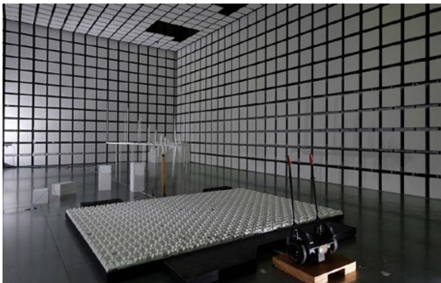
写真 4 ECM 試験関連エリアの電波暗室。さまざまな種類、強さの電波の飛び交う生活環境でもロボットが誤動作を起こさないか、また、ロボットが発する電波の影響について調べる
