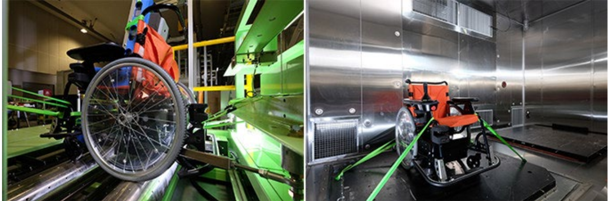
写真 3 強度試験関連エリア。走行強耐久性（左）や、過酷環境耐久性などを調べる
