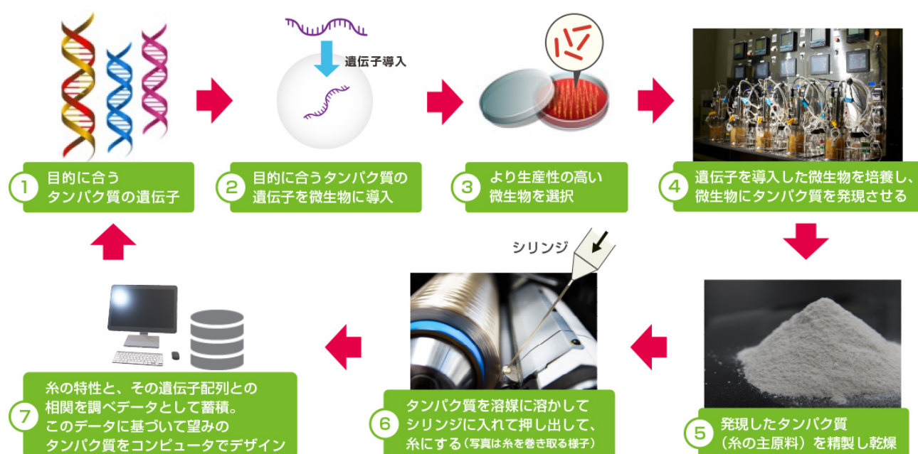
図1 目的用途のタンパク質の生産方法（写真提供：Spiber）
