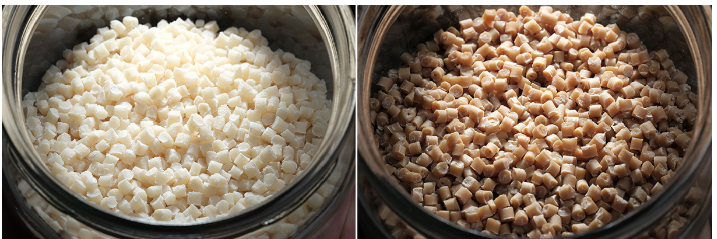
写真4 星光PMCのCNF配合樹脂「STARCEL®」（左：CNF強化ポリエチレン、右：CNF強化ポリプロピレン）
