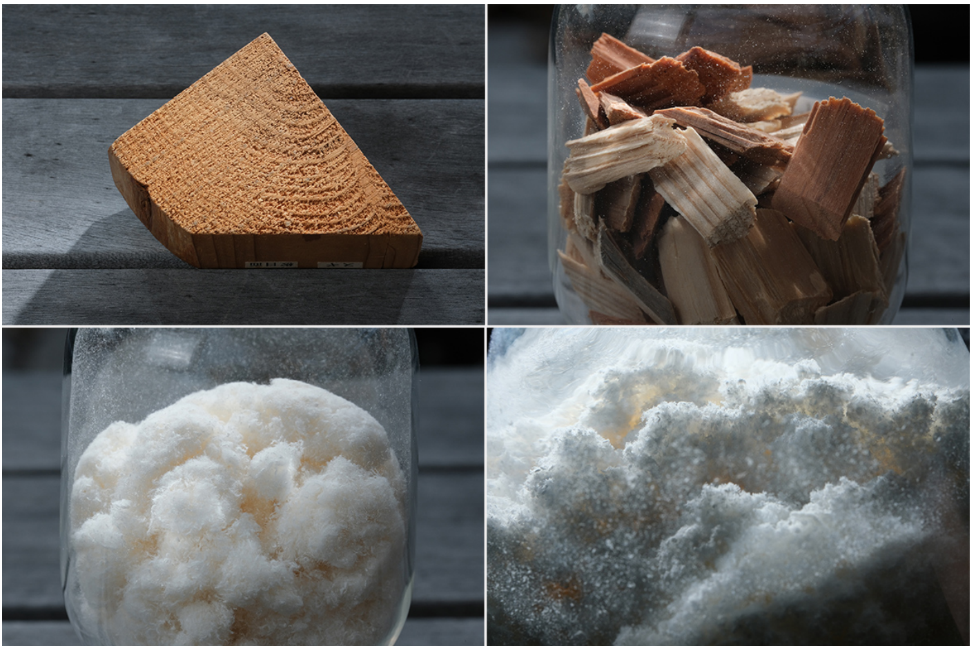
写真1 （左上）木材、（右上）チップ化した木材、（左下）加熱・加圧して溶解させて得たパルプ、（右下）疎水化した変性パルプ
