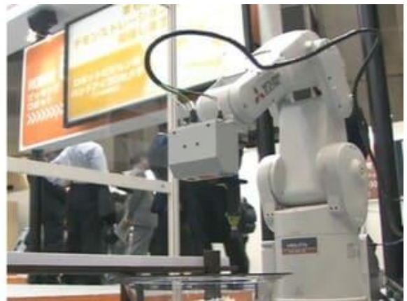
写真4 世界最小・最軽量のため、ロボットアームと一体化できるビジョンシステム（左）機体が搭載されたアーム（右）（写真提供：YOODS）
