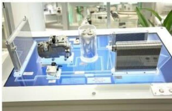
図2(左) ヒートポンプの構成(青線が暖房時の冷媒の流れ)(資料提供:デンソー)
