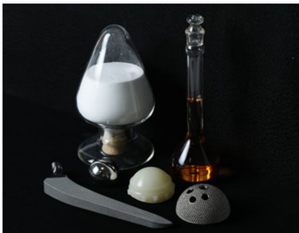
写真4 人工股関節の構成部材。中央の白い半球体が摺動部材の「BLEND-E®XL」。超高分子量ポリエチレン（左奥の白い粉）とビタミンE（右奥の茶色い液体）を混練・成型して作られる。手前はチタン合金製の大腿骨ステム（左）と寛骨臼コンポーネント・カップ（右）
