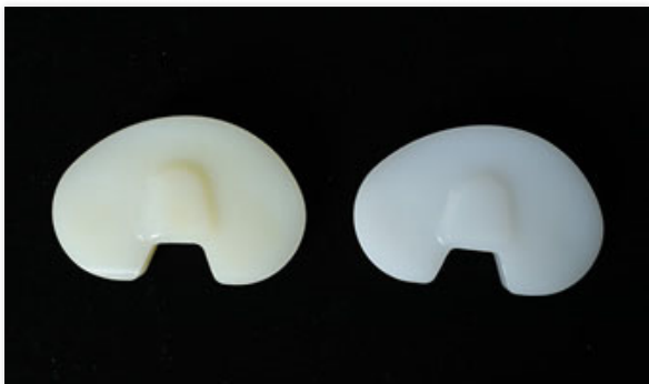
写真3 ビタミンE配合の膝関節用摺動部材「BLEND-E®」（左）とビタミンE未配合（右）のサンプル。ビタミンEを配合すると黄味がかかった色になる
