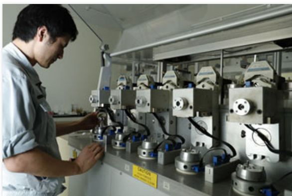
写真5 股関節の動きを再現する専用のシミュレーターで、500万歩分の歩行でも摩耗がほとんどないことを検証した
