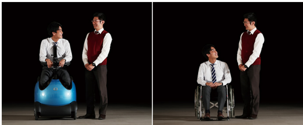
写真6 ロデム（左）と車椅子（右）におけるユーザーの目線の高さの違いは明らか
