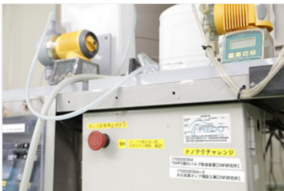
写真4 CNF研究所に設置されているTEMPO酸化CNF製造装置
