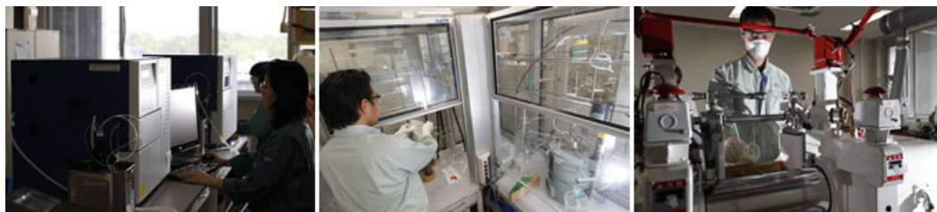
写真3 杜仲に含まれるTPI分子量分布の測定装置（左）、化粧品等の基礎材料の調製室（中央）、材料を圧延する装置（右）
