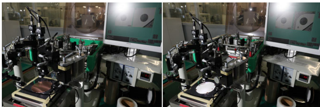
写真5 FGHP（手前左の円盤状の物）に無機塗料を塗布する様子。左写真の状態から白い塗料が塗られ、右写真の状態へ
