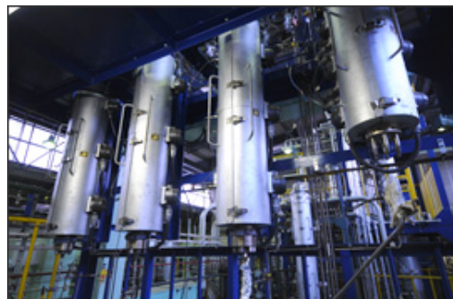
直径30cm、高さ2mの脱硫塔試験機
