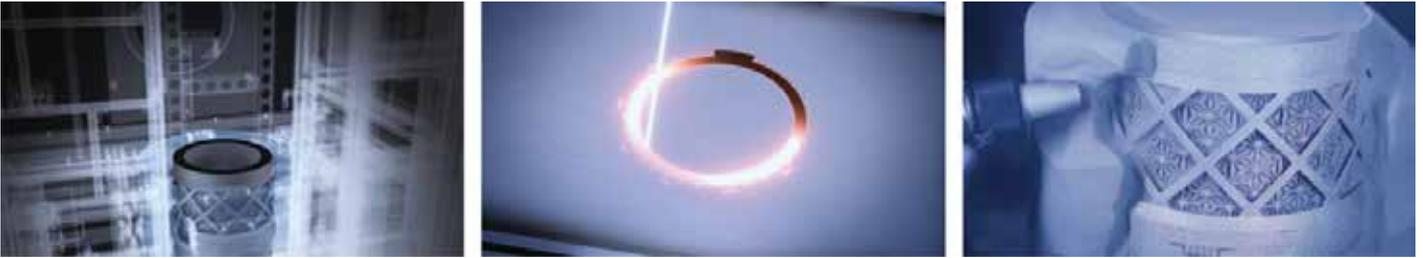
写真 12 パウダーベッド方式による電子ビーム金属積層造形法の続き
