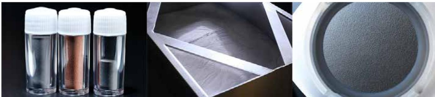
写真8 「JAM-5200EBM」に使用されている金属粉末
