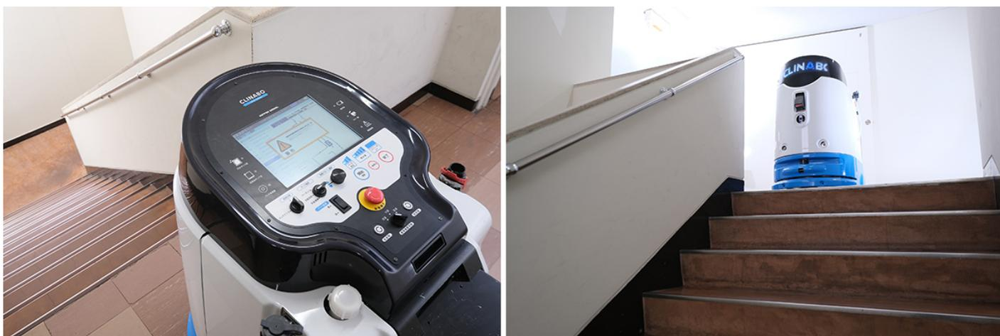
写真9 段差を自動検知して停止した「CLINABO」
