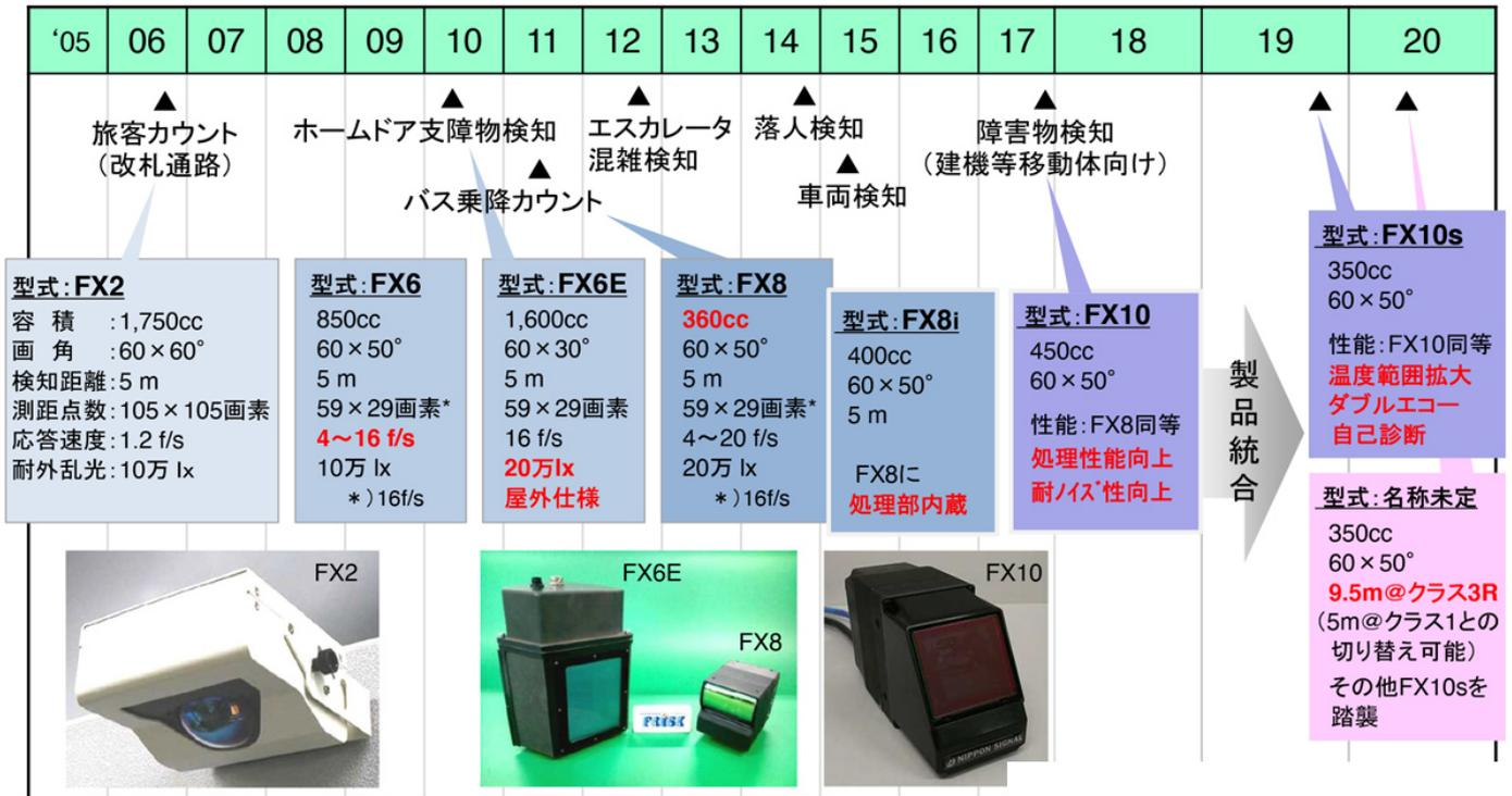
図9 「アンフィニソレイユ」の開発年表（資料提供：日本信号）
