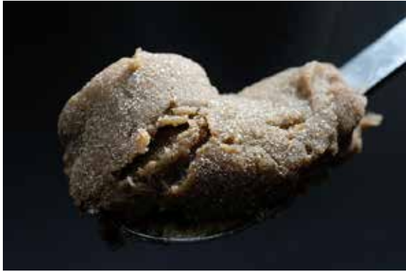
写真8 スラリー状態でも高い粘度を持つキャッサバパルプ。発酵のため加温するとさらに粘度を増すため取り扱いが難しい
