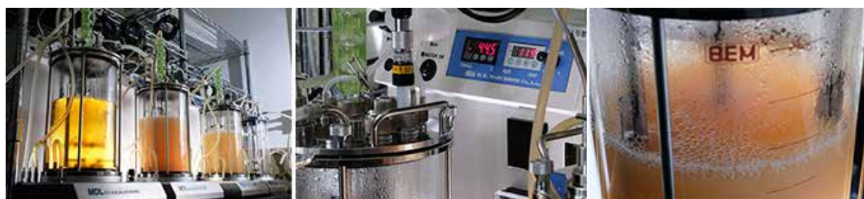
写真9 磐田化学工業では「耐熱性酵母」の大量供給に向けて培養評価の研究が続く。（左）生育環境を変えての評価（培養温度と攪拌速度がそれぞれ異なる）、（中）40℃を超える発酵温度、（右）培養が進んで濁る容器、「耐熱性酵母」は培養速度が速いのが特色
