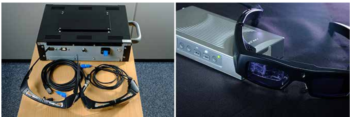
写真 5 初期プロトタイプはコントローラー部分だけでも A4 サイズもあり、総重量は 7kg を超えた (写真左)、9.5 代目となる最新プロトタイプはメガネ部分が約 60g、コントローラー部分も約 460g と、大幅な小型化・省エネ化を実現している (写真右)
