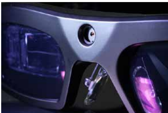
写真6 メガネ前面中央に取りつけられたカメラ。このカメラを通して見れば、目の前の現実世界をリアルタイムで見ることができる（拡大も可能）
