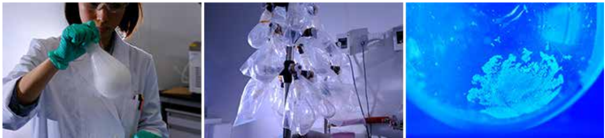
写真2 合成された「特殊ペプチド」は最終的に凍結乾燥装置で精製されて（左・中央）、粉末状の固化物となる（右）。試料の入ったフラスコが凍結乾燥装置に設置されている様子（中央）
