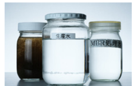
写真 1 処理前の下水（左）、MBR 処理後の水（右）、統合システムでの最終生産水（中央）
