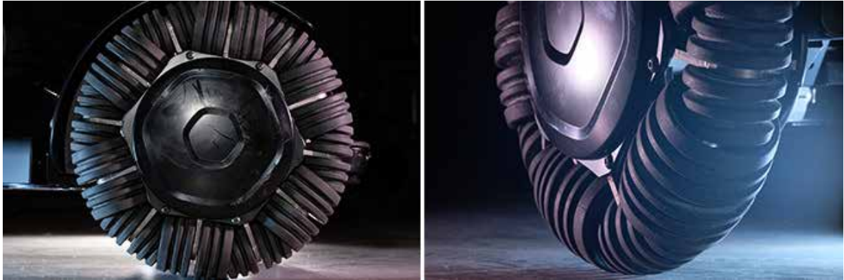
写真 3 進行方向に垂直に設置された大小のサブタイヤが特色の WHILL の「オムニホイール」
