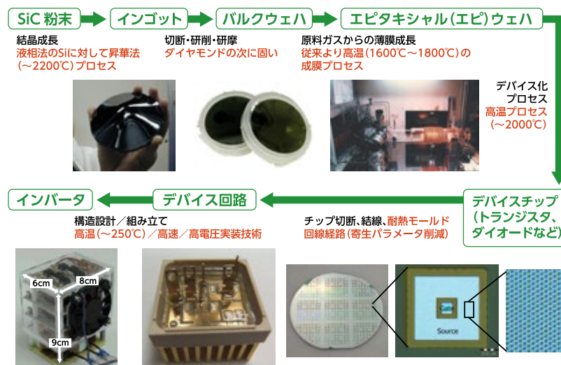
図 4 SiC 材料からインバーター成立に至るまでの研究プロセス (資料提供：産業技術総合研究所)
