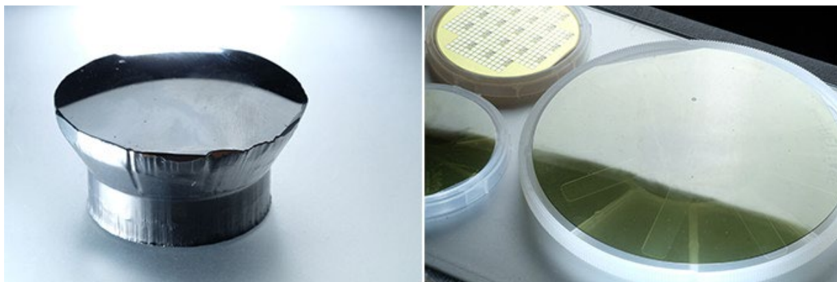
写真2 SiC 半導体の材料となるインゴット（左）、切り出されたウエハ（右）
