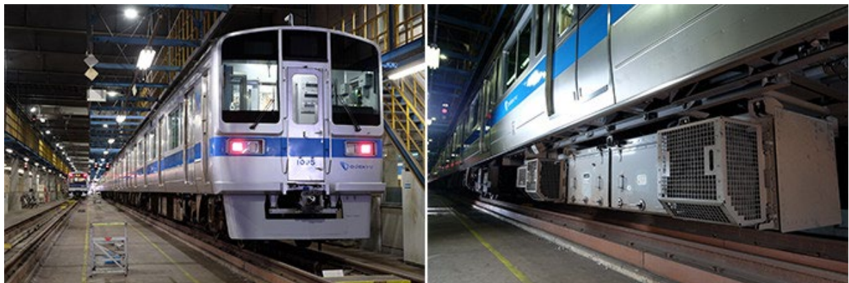
写真 1 フル SiC インバーターが搭載された小田急電鉄 1000 形リニューアル車 (左)、床下に設置された「フル SiC インバーター」(右)
