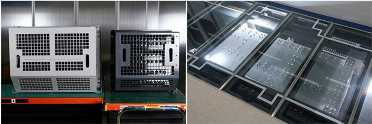
写真6 Si適用インバーターと、SiCパワー半導体適用インバーターの大きさ比較。白色の装置が従来のSi適用インバーター（左）、電車のカットモデルでの床下設置の大きさ比較、白い枠が従来のインバーター（右）
