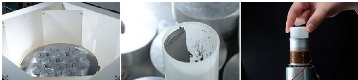
写真2 東京工業大学での研究開発では、35mm フィルムのケースを試験容器にして、さまざまな混合割合のセメントをつくり、反応や硬化速度などを試した
