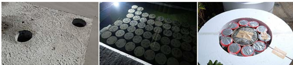
真8 現在も品質管理のための実証試験は続いている。(左) 作成した大型の試験体からは定期的にコアを引き抜いて状態を検査する、(中) 管理用の水中養生テストピース、(右) マスコンクリート構造体中の温度上昇の試験
