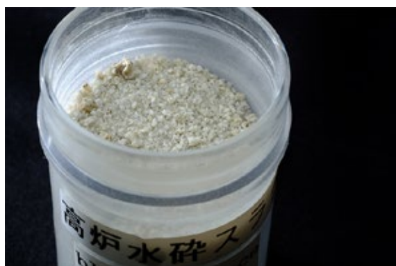
写真1 高炉セメントの原料となる、高炉スラグを水で急冷した後、乾燥・粉砕・粒度調整した「高炉スラグ微粉末」
