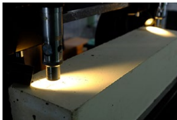
写真11 日鉄住金高炉セメントの研究所での乾燥収縮試験
