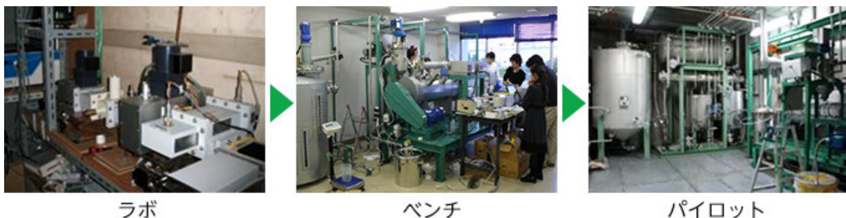
図2 スケールアップの変遷。左から、ラボスケール、ベンチスケール、パイロットスケールのリアクター (画像提供：マイクロ波化学)
