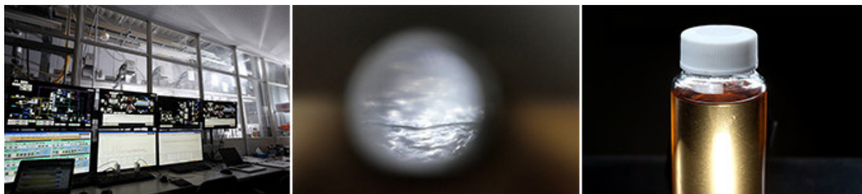
写真6 住之江工場のマイクロ波制御室(左)、リアクター内で反応中の製品(中)、インク溶剤となる製品(右)
