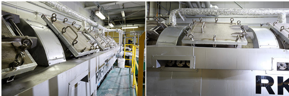
写真3 同社住之江プラントのリアクター(左)、リアクターの各槽は反応の順に傾けて配置されていて、次の槽へと溶液が自然と流れ込むように設計されている(右)
