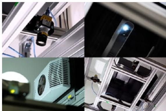
写真5 レンズ（上段左）、プロジェクター部（上段右）、空冷ファンには制御盤などに使われる汎用品を使用してコスト削減を図っている（下段左）、ビジョンヘッドを下から見上げた状態、中央の黒い部分がプロジェクター（下段右）
