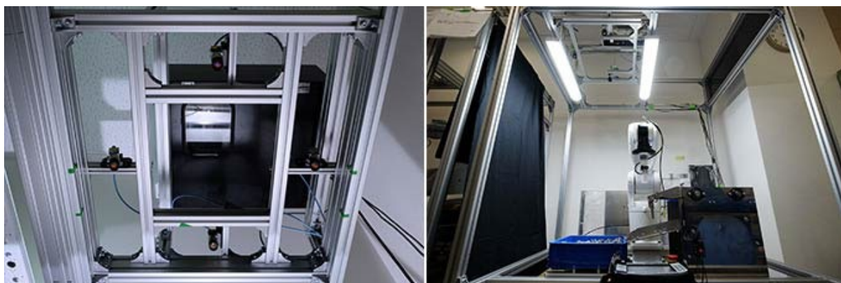
写真4 4台のカメラを備えた「TVS」シリーズの最新型「3.0」（左）、その産業ロボットとの組み合わせ例（右）
