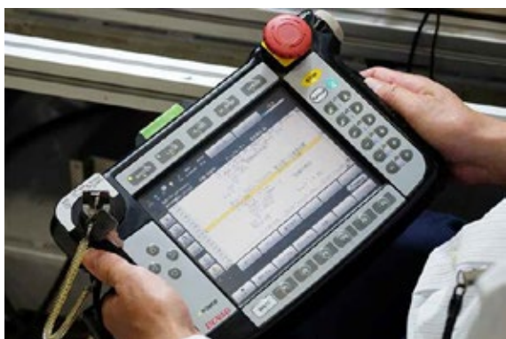
写真6 ハンディ操作器。既存のロボットペンダントで操作できる上、3次元マッチングの様子はリアルタイムにモニターで確認できる
