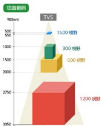
図5 ピッキング範囲を変更することで様々な大きさの部品のピッキングが可能（資料提供・三次元メディア）
