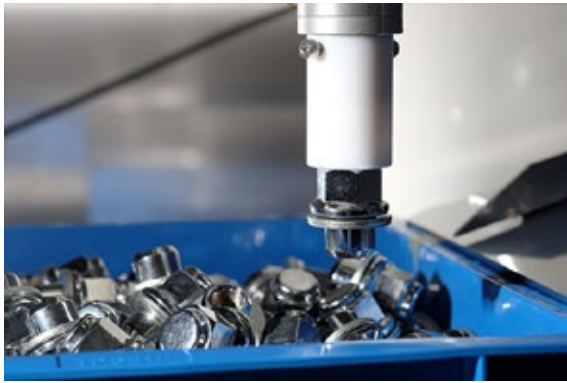
写真1 従来の生産ラインでは人手または専用機を使ってばら積みされた部品を整理する必要があったが、「TVS」シリーズを導入することでばら積みのままで部品をピックアップできるようになる
