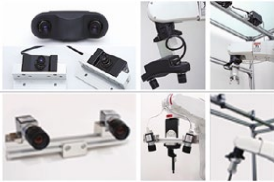
写真2 歴代の「TVS」シリーズ。「TVS1.0」(上)、「TVS2.0」(下)。「1.0」と「2.0」は人間と同じ二つの目でモノを認識する(画像提供・三次元メディア)
