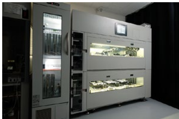
写真4 中辻名誉教授がニプロと共同開発した幹細胞用自動培養装置の試作機、最新機は「CELLAFORTE®(セラフォルテ)」として、2016年4月から本格的に発売開始した
