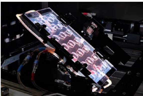
写真8 培養バッグの回転機能
