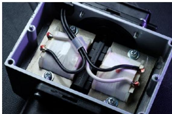
ダイヤフラムを動作させる電磁石が入ったプロワ内部
