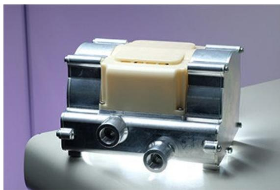
燃料ガスから水素を取り出す家庭用燃料電池システムなどの改質型とは違い、車両用燃料電池システムなどの純水素型ではもともと純水素を燃料としています。また、発電効率を上げるために、発電段階で反応せずに排気に残った水素を再度発電に利用します。「水素循環プロワ」は、その残留した水素を昇圧・循環するために使用する装置です。
