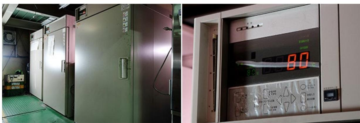
(左) 補機プロジェクトで加速試験用に導入された3台のオーブン (右) 温度設定パネル
