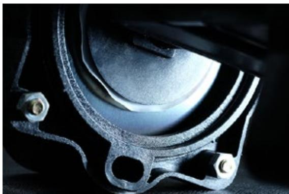
電磁式ダイヤフラムプロワのダイヤフラムの部分
