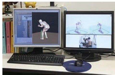
図3 人間の動きをシミュレーションするモーション・キャプチャー
