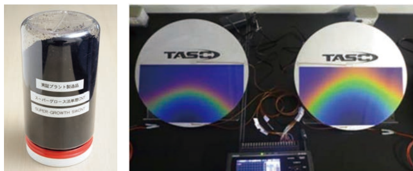
図8 当プロジェクトの成果 左) 実証プラントで大量合成できるようになったスーパージグロース法単層カーボンナノチューブ 右) アルミとカーボンナノチューブの複合材。高い熱伝導率、高い放熱特性をもつ(提供:産総研)
