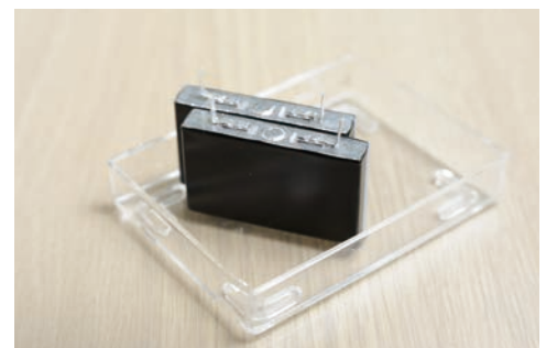
図2 NEDOの「カーボンナノチューブキャパシタ開発プロジェクト」で開発されたスーパーキャパシタ
