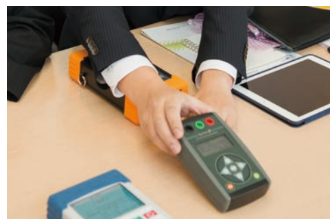
図8 漏電の一種、地絡を検出する装置「地絡検出器20G」
