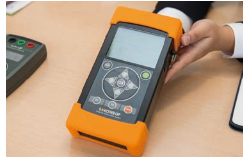
図9 断線と地絡とを1台で推定できる新製品「SOKODES GF (ソコデスGF)」
