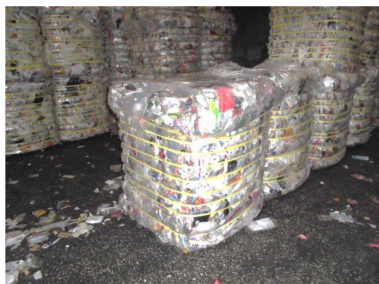
自治体から回収された1m角の廃プラスチック束 (提供:JFEスチール株式会社)
