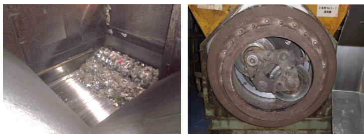
破砕機(左)で破砕後、造粒機(右)で圧縮固化され造粒プラスチックに加工 (提供:JFEスチール株式会社)
