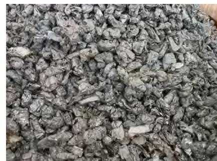
磁力選別機によって回収された鉄
