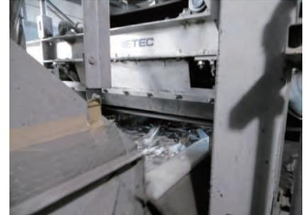
家電リサイクルを一連の流れで効率良く行うために最適化された磁力選別機
