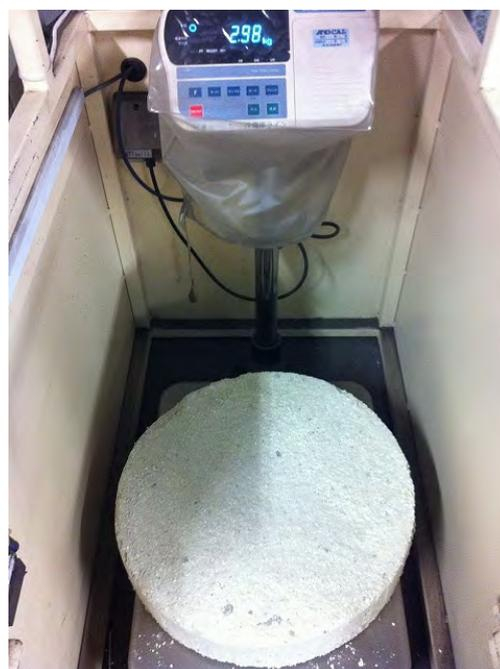
破碎してフロンを回収した後に圧縮されたウレタン
