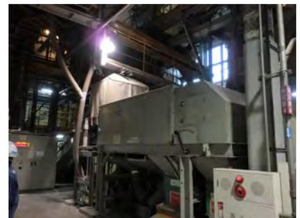
非鉄金属を回収する渦電流選別機
