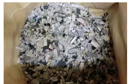
回収されたプラスチック。東京エコリサイクルでは、独自の技術として二段風力選別機を開発し、ウレタンとPVC類を混合プラスチックから除去(選別)している
