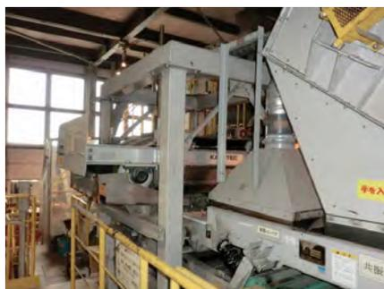
磁石の力を利用して鉄を選別する磁力選別機
