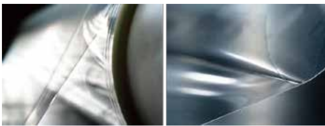
パナソニックが開発した、可視光応答型光触媒を コーティングした透明フィルム。 剥離シートから剥がして、必要なところに 貼り付けるだけで使用可能
