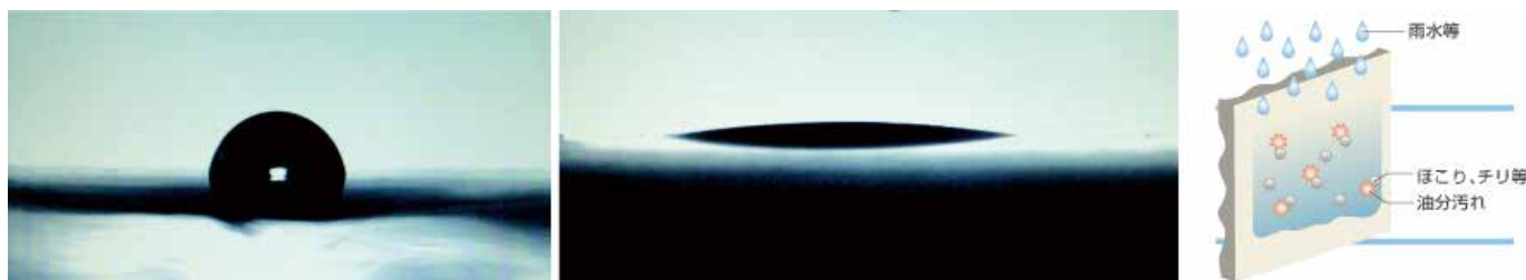
図1(左) 照射前の撥水状態、(中央) 照射による超親水状態、(右) 超親水状態では、塗料表面のチリ、ホコリが、雨水によって流されます。
