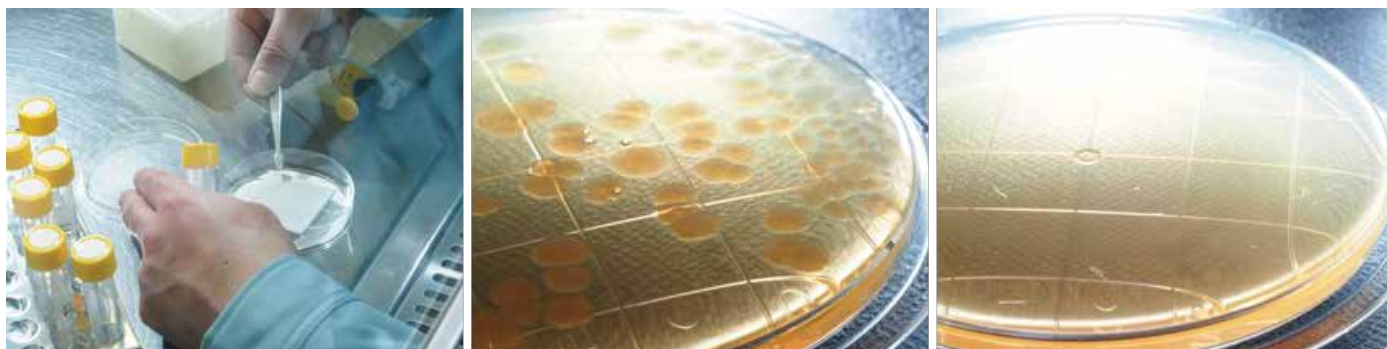
TOTOで行われている抗菌性能試験(左)、 光触媒無しのシャーレ(中央)と光触媒を塗布したシャーレ(右)
