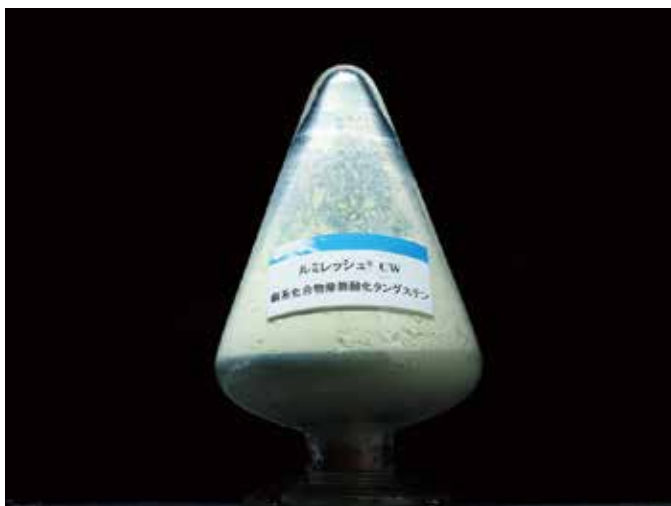
昭和電工セラミックスが「ルミレッシュ®CW」の製品名で量産化した銅系化合物修飾酸化タングステン光触媒
