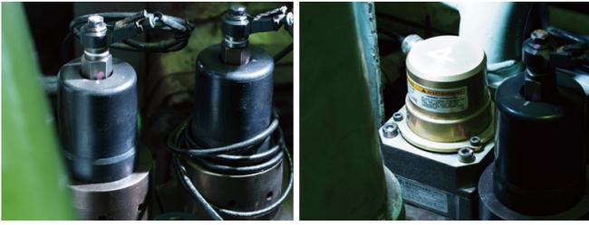
ノッキングを検出するセンサー(左)、ガス噴射弁(右)。シリンダーごとにひとつずつセンサーが自動でモニタリングしており、ノッキングを検出すると、空燃比の調整システムが作動する
