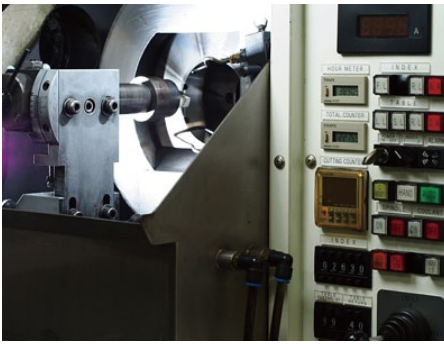
ダイヤモンド内周刃ドラム式切断機(左)、 切断機用のダイヤモンド内周刃ドラム(右)
