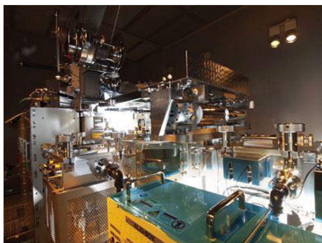
CLBO 波長変換素子が搭載されているフォトマスク検査装置 (ニューフレアテクノロジー社 NPI-7000)
