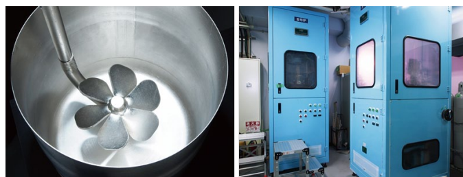
加温回転るつぽと固定プロペラ(左)、電話ボックスにも似た閉鎖環境(右)で結晶を製造
