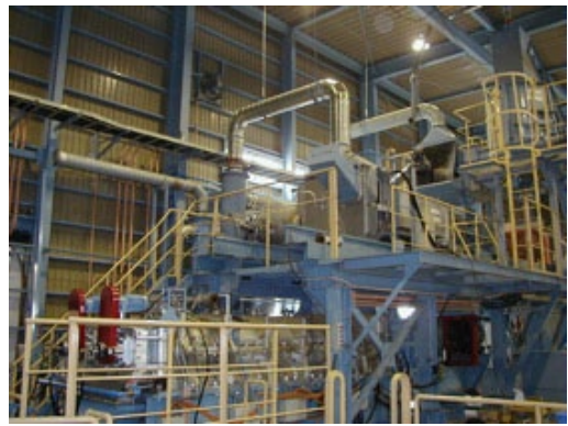
図7 改良された脱塩装置の構造図（左）と実証プラントに設置された脱塩装置（右） （写真提供：アーステクニカ・関商店）
