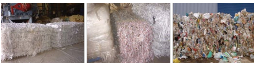
原材料別などにしっかり分別された状態で入荷する産業廃棄物の違い (左：ポリプロピレンのコート紙、中央：PET、右：プラスチック類が混合した一般廃棄物) (写真提供：アーステクニカ、関商店)
