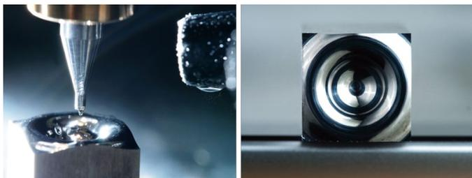
超硬度合金のスミダイヤバインドレスによる切削、研磨（左）、美しく鏡面に仕上がった工作物（右）
