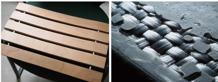
すのこ状座面の試作機（左）と、内部にグラスファイバーを編み込んだ座面の試作機（右）
