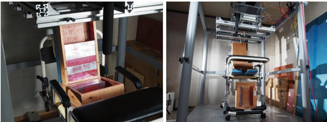
鉄製のおもりを移乗器に載せて強度や耐久性をチェックする落下試験装置。
