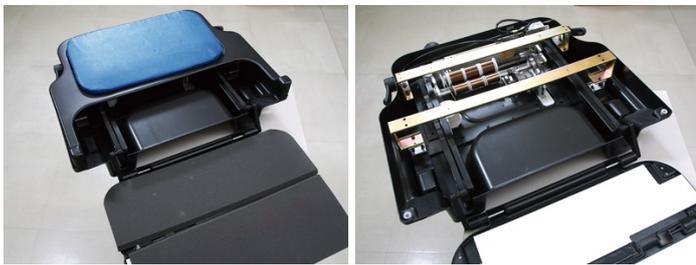
NEDO 事業採択時に試作されていた、ばねとベルトを組み合わせたワンタッチ式の座面収納機構。コスト、重量、操作性、耐久性など、改良すべき点がまだ多く残されていた
