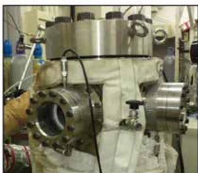
左) 図9 高温高压容器（エンジン筒内状態を再現可能）
