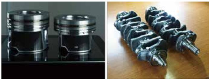
(左写真) 従来型ピストン (左) と SKYACTIV-D のピストン (右) では、高さがかかなり小さくなっていて、重量も 100g も軽量化した。(右写真) クランクシャフトも、SKYACTIV-D(右)では従来型 (左) より 3kg 軽量化。その分機械抵抗が減り、騒音減や燃費向上などにつながった
