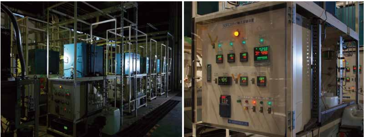
大阪ガスの研究施設内でのセルスタックの耐久試験。青い箱の中にセルスタックが収められている（左）。 様々な劣化用要因や条件を組み合わせることで加速試験を行った（右）
