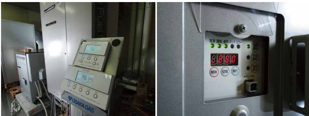
大阪ガスの研究施設で続く連続稼働試験（左）、総稼働時間（1,260 時間）表示（右）
