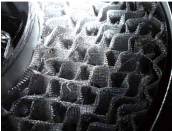
当初、実験に使用していた網状の充填物
