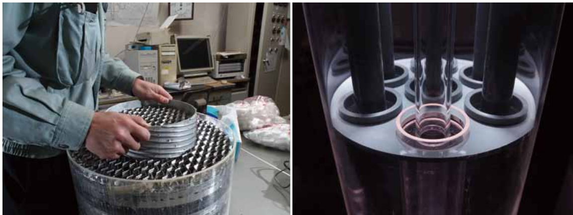
商用機用の二重管のサンプル（右）、HIDiCの塔内部構造の模型
