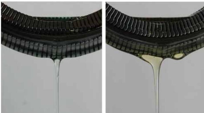
右写真の現行油に比べて、左写真の出光興産と岩手大学森教授の開発した潤滑油は、低粘度でありながら高い摩擦係数を実現している
