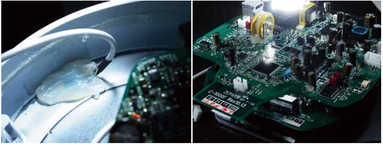
強風時にかけるブレーキによる筐体内の温度上昇を監視するセンサー（左）、 微風から強風まで自ら考えて発電するエアドルフィンの制御基板（右）
