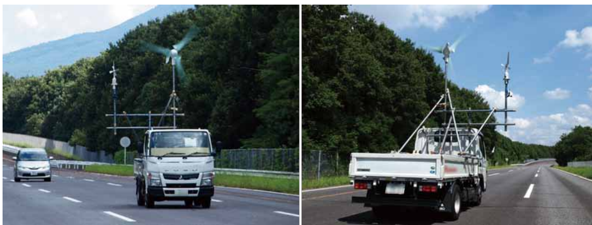
産業技術総合研究所つくば北センターのテストコースでのトラックの荷台にエアドルフィンを固定しての実験
