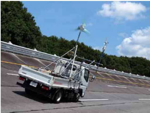
風速 30m/ 秒の強風、 しかも複雑に風向が変わっても 追尾して発電を継続できるか、自動車の テストコースを使って実験を繰り返した
