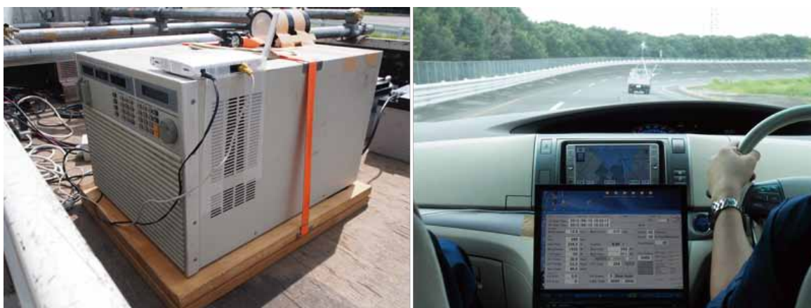
荷台にはデータの収集・解析装置が（左）、追走する車両にリアルタイムでデータを送る
