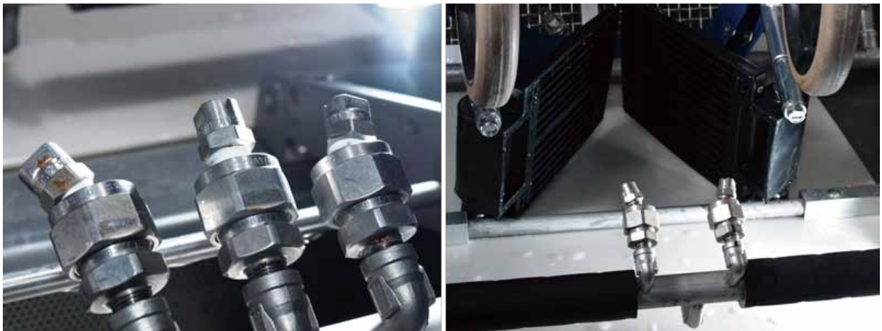
車いすをくまなく洗浄できるように着けられたノズル。
