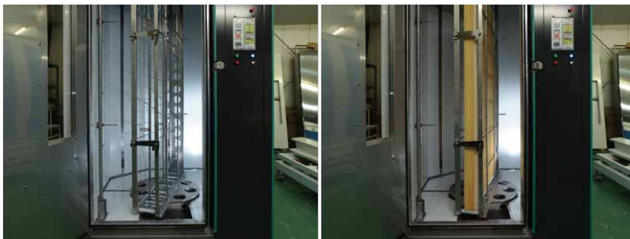
自動洗浄乾燥機へのマットレスのセッティング方法
