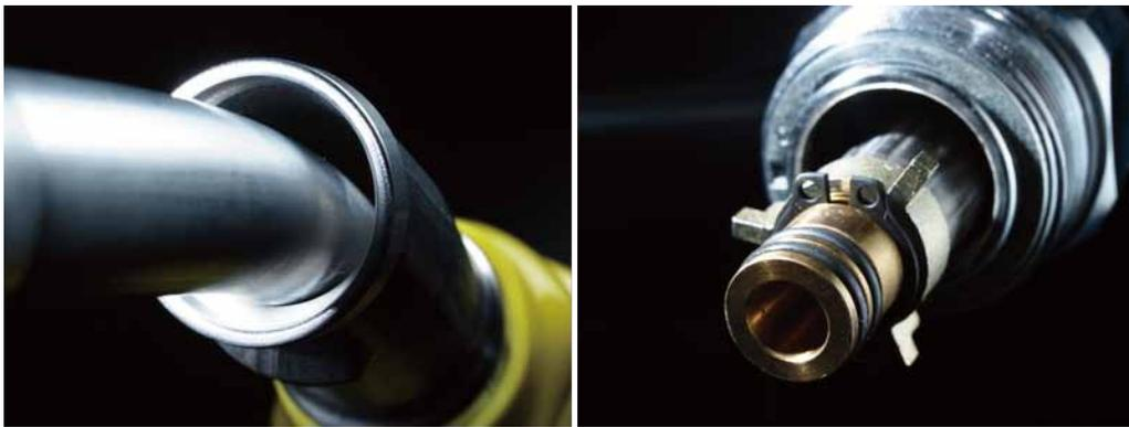
エコステージの給油ノズル（左）にはベーパーを回収吸引する隙間がある。ホースも二重構造になっていて（右）、外側の通路がガソリンの給油路で、ガソリンベーパーは内側の金属部分の隙間を通して回収されていく
