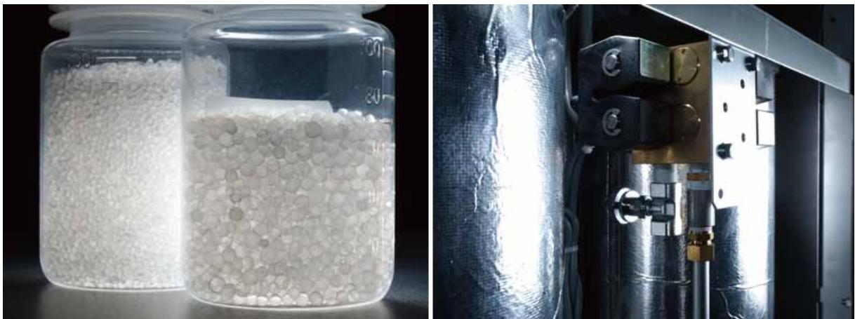
「エコステージ」の高濃度化システム（左写真が吸着剤、右写真が吸着塔）。
