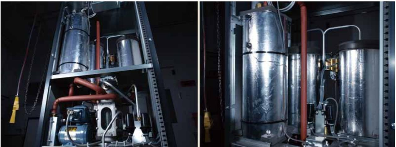
(左の写真) 凝縮器、ポンプ、液化確認窓、高濃度化装置（吸着塔）などが詰まったエコステージD型の内部、(右の写真) 左側の大きな円筒形の装置が凝縮器
