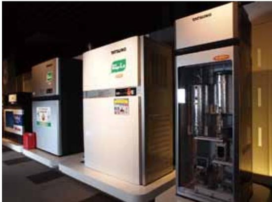
ショールームに並ぶ「エコステージ」、右のカットモデルが給油時のベーパーを回収するD型、左の2機がローリーからスタンドへ荷卸し時に発生するベーパーを回収するL型
