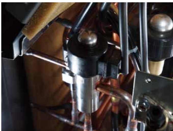
エコキュートに搭載されているエジェクタサイクル
