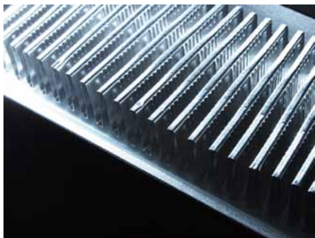
着霜対策縦溝加工されたアルミ熱交換機。フィンのルーバー角を緩やかにするほうが着霜しにくく、除霜しやすい
