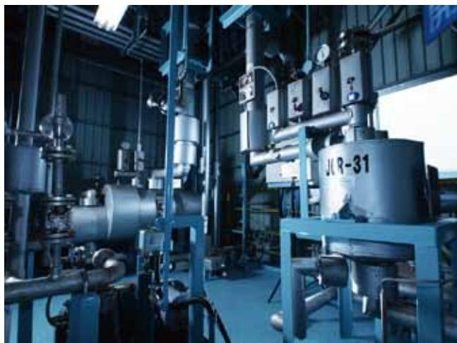
実証プラントの第 1 蒸留塔（右）と精製塔（左）
