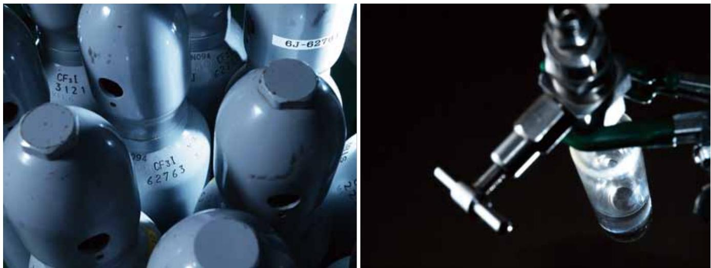
東ソー・エフテックが製造しているヨウ化トリフルオロメタン (CF<sub>3</sub>I)。ボンベ（左）、耐圧容器内では無色透明の液体状態（右）
