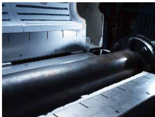
度重なる試行錯誤の末、 $\text{CF}_3\text{I}$  の合成、量産化を可能にしたロータリーキルン
