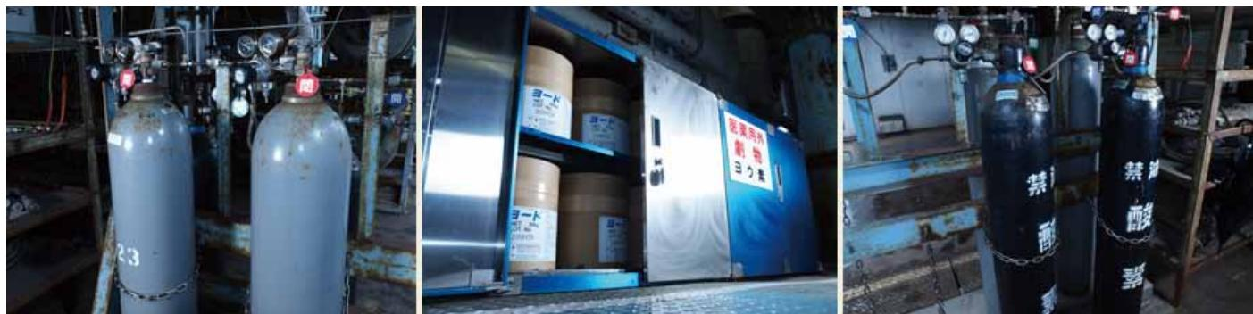
$\text{CF}_3\text{I}$  の原材料となる、 $\text{CHF}_3$ 、ヨウ素、酸素（東ソー・エフテックの実証プラント）
